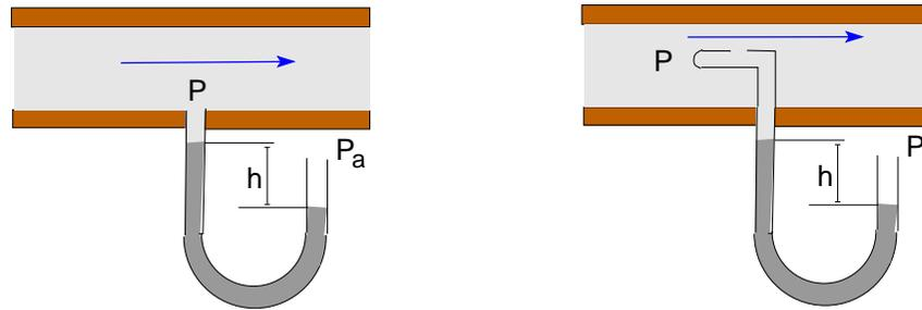
La diferencia de alturas del líquido del manómetro es proporcional a la diferencia entre la presión atmosférica y la presión en el fluido.
