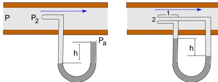
*El tubo de Prandtl* (derecha) (también se le llama tubo de Pitot) combina los dos efectos anteriores  $\Rightarrow$  compara la presión del fluido en los puntos 1 y 2 (punto de remanso)  $\Rightarrow$
