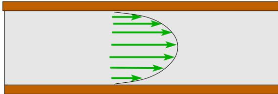
⇒ La velocidad máxima ocurre en  $r = 0$  (centro del conducto) y es proporcional al cuadrado del radio del conducto y a la variación de presión por unidad de longitud  $\Delta P/\Delta L$  (*gradiente de presión*).
