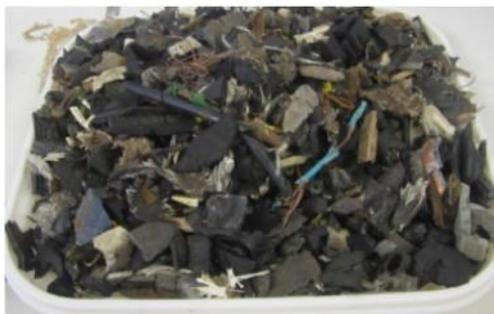
*Figura 2.1- 1 Muestras de plásticos provenientes de desechos vehiculares.*
