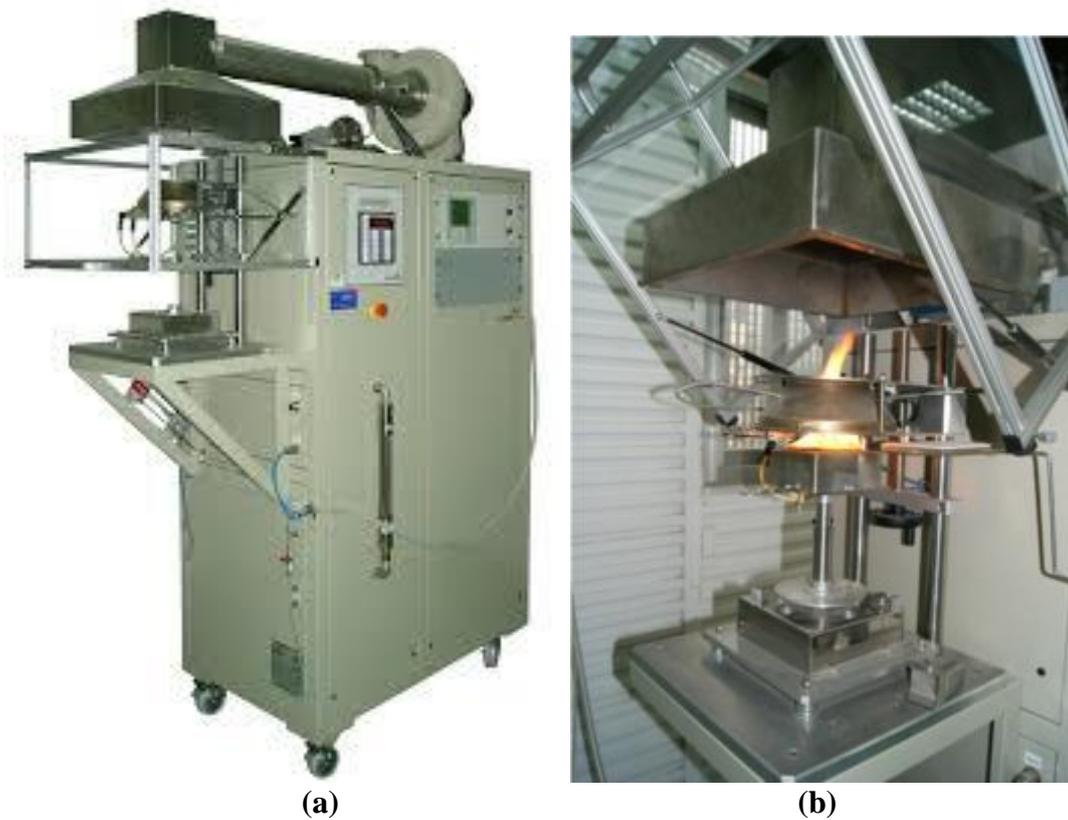
Figura 1. 24 Equipo del cono calorimétrico (a) y evaluación de la muestra en el cono
