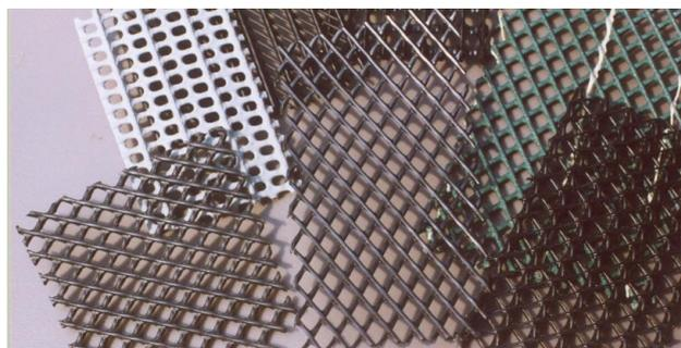
Figura 17: Geomallas (Material de clases de Ingeniería Ambiental III).
