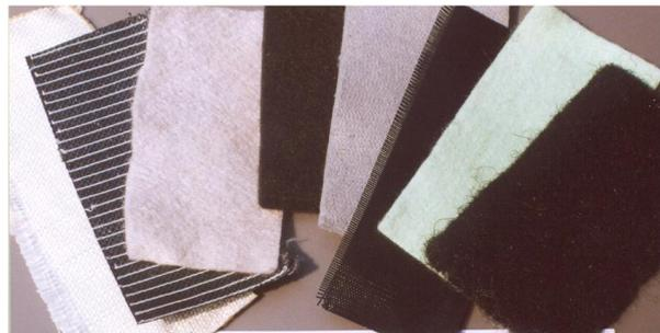
Figura 16: Geotextiles (Material de clases de Ingeniería Ambiental III).
