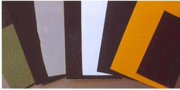
Figura 15: Geomembranas (Material de clases de Ingeniería Ambiental III).
