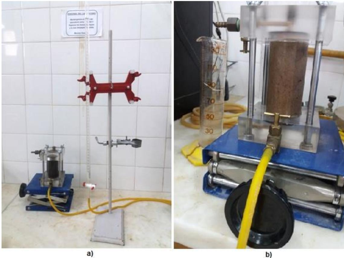
Figura 40: Ensayo de conductividad hidráulica. a) Muestra escoria, b) Muestra limo + 20% escoria.
