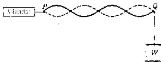
Figura 58. Una cuerda sometida a una tensión por el cuerpo W está conectada a un vibrador. A una frecuencia fija, los patrones de la onda estacionaria se formarán para ciertos valores de la tensión en la cuerda.
