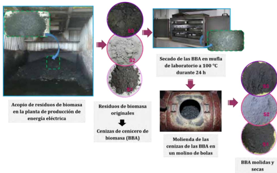
Figura 3.1 Tratamiento inicial de los residuos de biomasa (cenizas de cenicero, BBA) procedentes de plantas de producción de energía y calor empleadas en la presente tesis.
