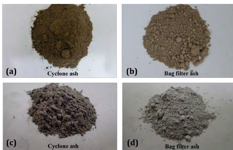
Figura 1.19 Apariencia externa de las cenizas de ciclones (a) y (c) y de los filtros (b) y (d) para las plantas A y B, respectivamente. Basada y modificada de Maeda et al. (Maeda et al. 2017)
