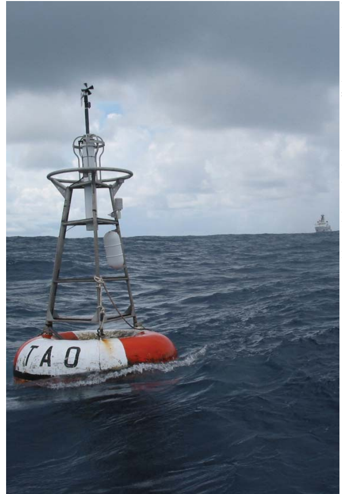
Boya para la medición meteorológica y oceanográfica en el Pacífico ecuatorial.
