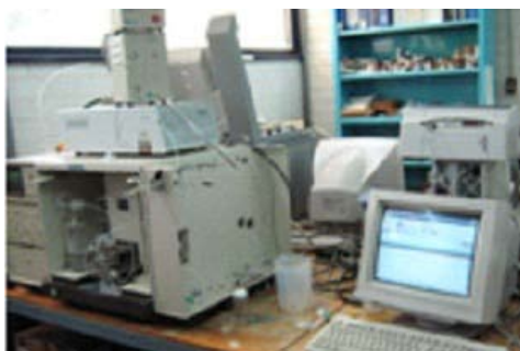
Fig. 17. Cromatógrafo Varian utilizado para el estudio de monosacáridos.
