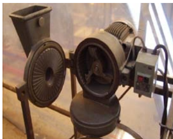
Fig. 16. Molino Retsch GmbH 5657 HAAN con el que se efectuó la molienda del material.
