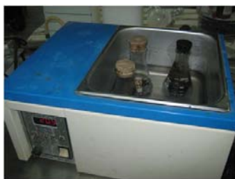
Fig. 19. Baño maría con agitación y temperatura controladas para efectuar la hidrólisis ácida de L. rotundiflorus .
