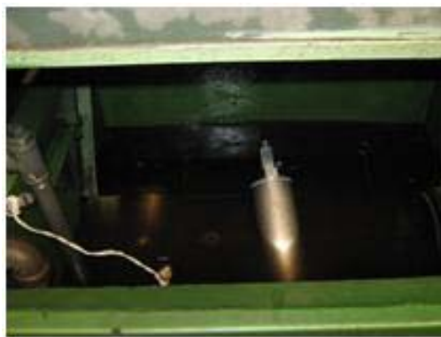
Fig. 24. Baño de aceite de silicón en el que se efectuaron los pretratamientos con Pxa y POM's. El sistema está equipado con resistencias que calientan el baño y una flecha giratoria en la que se sujetan los microdigestores.
