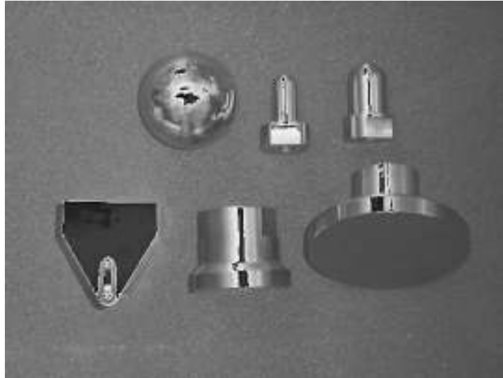
Figura 3.2.1.2.8: Distintos cabezales de impacto intercambiables. Los tres de la fila superior corresponden a cabezales de impacto en indentación con cabezal hemisférico y radios respectivos de izquierda a derecha 50mm, 13 mm y 20 mm. En la fila inferior, aparecen, de izquierda a derecha respectivamente, el cabezal de impacto en flexión y los dos de impacto plano, con diámetros respectivos de 50 mm y 80 mm.
