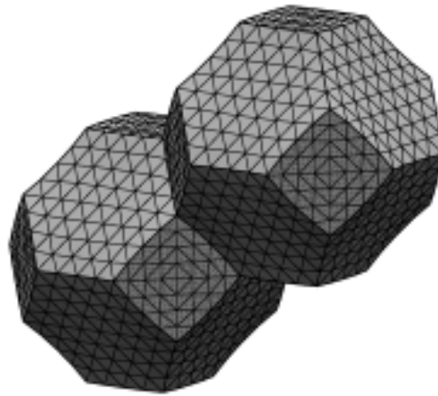
Figura 2.1.4: Dos tetrakaidecaedros, poliedros formados por 14 caras de las cuales ocho son hexágonos y seis son cuadrados.
