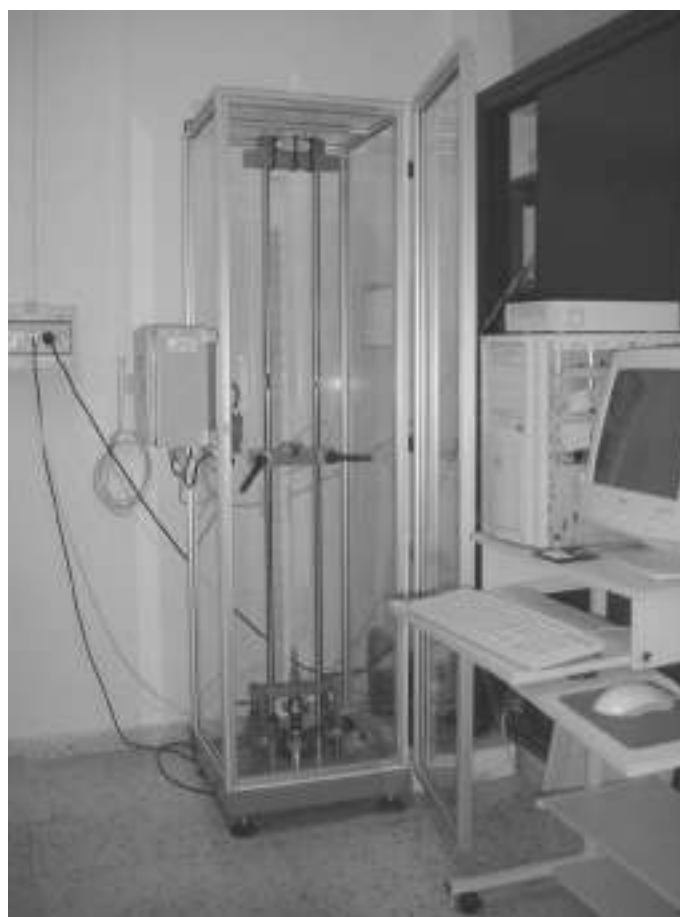
Figura 3.2.1.2.6: Fotografía de la torre de Impacto
