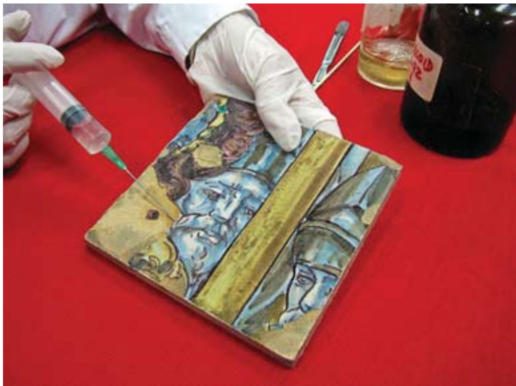
Figura 108. El meticuloso y arduo trabajo de consolidación del esmalte de cada azulejo recuperado.
