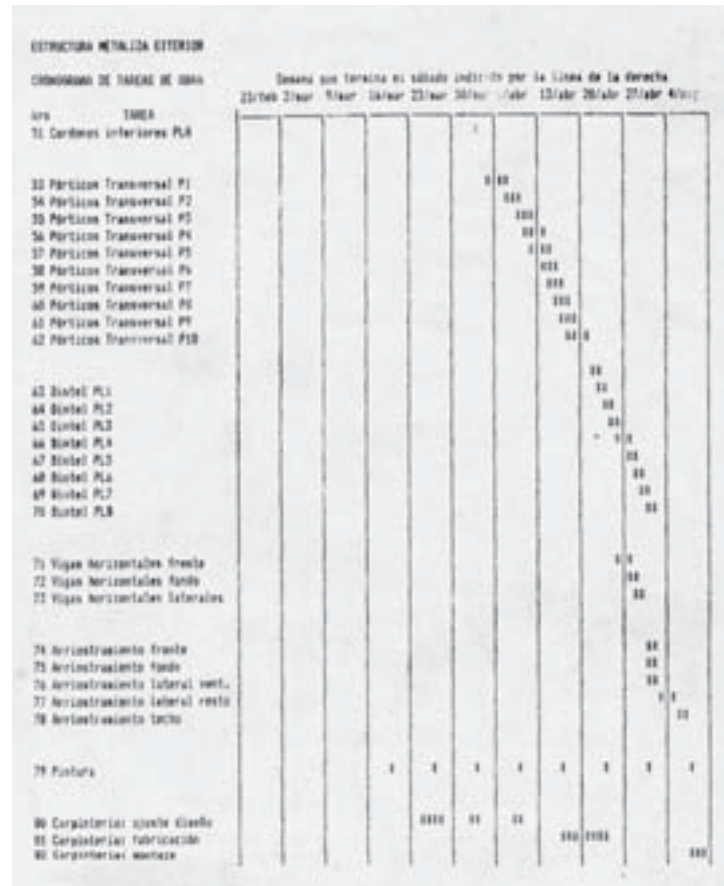
Figura 234. Cronograma de las tareas de obra a lo largo de cuatro meses para la extracción del mural y construcción de la estructura de soporte.
