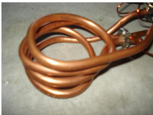
Figura 3. Dentro de la bobina L1 se introducen los materiales a calentar.
