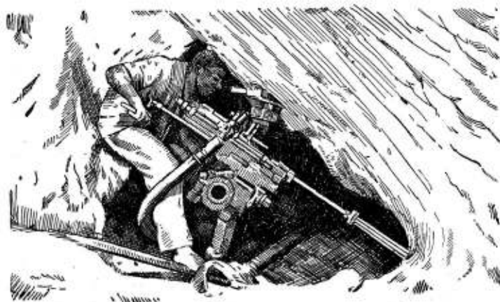
Minero africano, en una mina de oro, trabajando con una máquina perforadora. Estas máquinas abren los agujeros donde se colocan los cartuchos de dinamita, que, al hacer explosión, pulverizan las rocas
