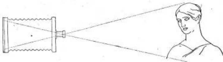
Fig. 13. — Los objetivos para retratos en sus cualidades son lo contrario de un «gran angular», es decir, que se destinan a fotografiar objetos de tamaño reducido (figura humana, cabezas, bustos), un poco alejados de la cámara para evitar deformaciones, y sin que el objeto se reduzca mucho. Tienen «poco ángulo» y son «largos de foco»
