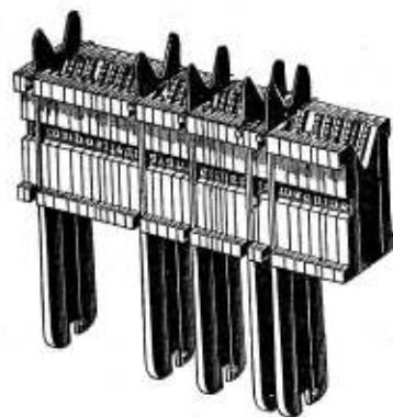
Matrices de una máquina de componer dispuestas para fundir una línea entera. Entre las palabras se muestran los espacios formando caña. Según estas cañas se aprietan más se ensancha la línea hasta llegar a la dimensión requerida.
