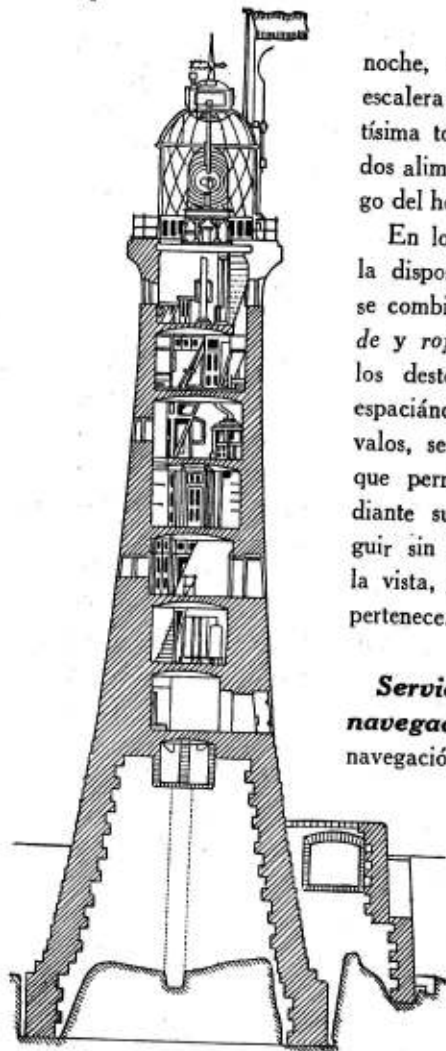
Corte esquemático de una torre de faro
