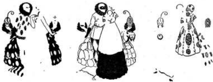
La primera figura es la exclusiva al color azul; la segunda al gris fuerte, y la tercera al bistro. El conjunto de estas planchas, impresas superponiéndolas con toda exactitud, da como resultado el «cromo»
