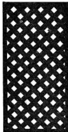
Fig. 1. — Trama muy aumentada. La trama es un cristal transparente, cruzado por una cuadrícula finísima de rayas negras y opacas.
