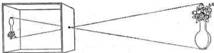
Fig. 1. — En la cámara oscura, un objeto externo e iluminado se reproduce invertido en la pared opuesta al agujero que permite la infiltración de la luz. (La inversión de la luz ocurre en virtud de leyes físicas que no cabe explicar en este artículo)
