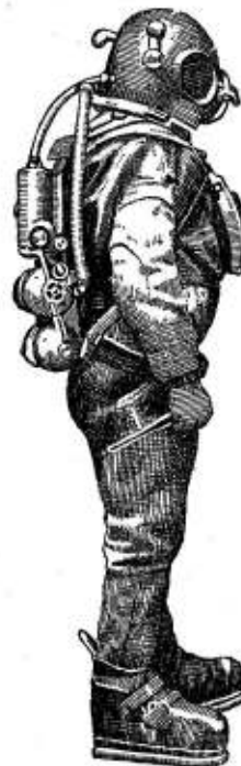
Escafandra sin tubo. El mecanismo sujeto a la espalda suministra el aire necesario, y el buzo tiene así una completa libertad de movimientos
