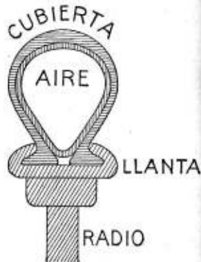
Esquema núm. 52. — Corte transversal de un neumático montado en su llanta
