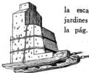
Patines de madera para el transporte de un coloso de piedra
