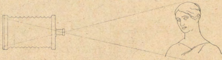
Fig. 13. — Los objetivos para retratos en sus cualidades son lo contrario de un «gran angular», es decir, que se destinan a fotografiar objetos de tamaño reducido (figura humana, cabezas, bustos), un poco alejados de la cámara para evitar deformaciones, y sin que el objeto se reduzca mucho. Tienen «poco ángulo» y son «largos de foco»
