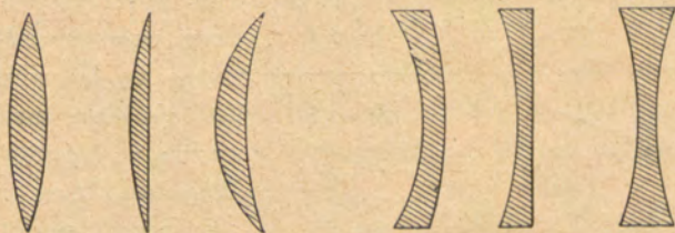
Fig. 4.—Esquema del corte de algunas formas de lentes que se emplean para fabricar objetivos fotográficos. Los tres primeros son convergentes, y los tres últimos divergentes
