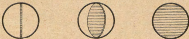
Esquema núm. 18. — Diversas posiciones de la llave de paso o «mariposa» que permite el acceso del gas ya formado a los cilindros. Esta llave actúa como las que se colocan en los tubos de las estufas y hogares
